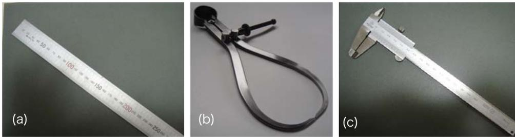
図 1: (a) スケール, (b) パス<sup>4</sup>, (c) ノギス。スケールとパスの機能をあわせ持つものがノギスです。
